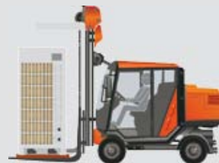
Перемещаются с помощью погрузчика
